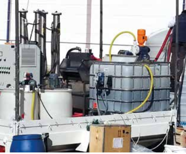
Elektroflokülasyon prosesli test tesisi
