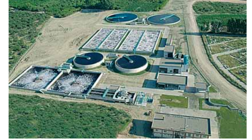
Yeşil Çevre OSB Atıksu Arıtma Tesisi, Bursa - Türkiye Kapasite: 52.500 m 3 /gün (410.000 E.N.)
